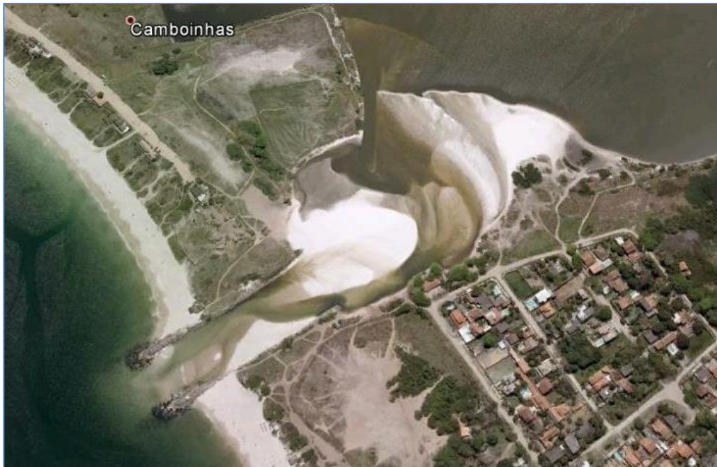
Figura 7: Foto de satélite do Canal de Itaipu. Chama-se a atenção para as barras formadas na embocadura lagunar do canal. Observa-se também assoreamento significativo em sua embocadura marítima, fatores que evidenciam um canal instável.
