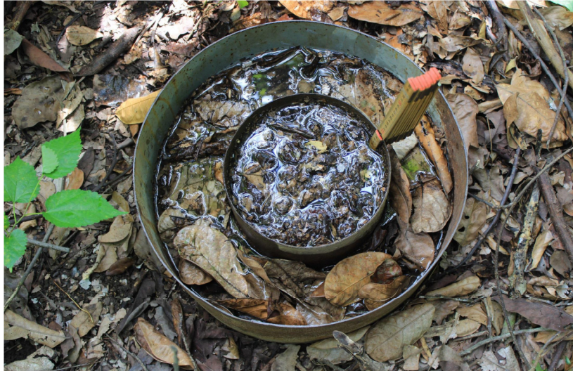
Figura 9: Infiltrômetro de duplo anel em uso. (Por Lara A. Oliveira, em dezembro de 2013)
