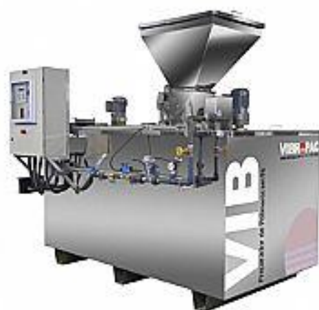
Figura 12: Exemplo de preparador de polímeros (Fonte: http://www.vibropac.com.br/ )
