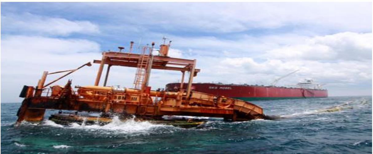
Figura 11 - Terminal de carga/descarga de petróleo e derivados com solução em monoboia em Tramandaí (RS) Fonte: Jornal do Comercio (2012)
