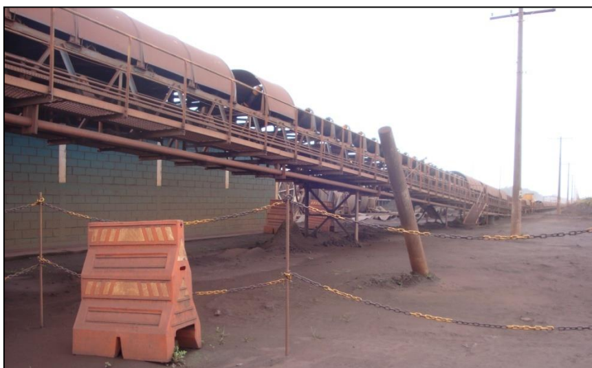
Figura 18: Esteiras transportadoras descobertas, facilitando a dispersão do material movimentado. (Fonte: Projeto Resíduos Portuários, 2012)
