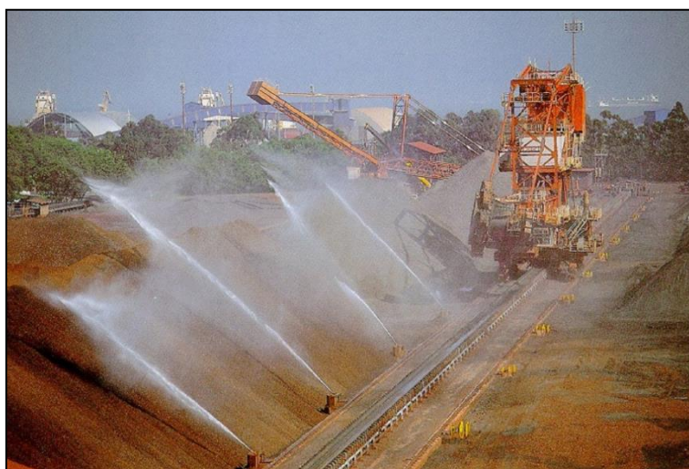
Figura 8: Aspersão de supressores nas pilhas de armazenagem (Fonte: REGATTIERI, 2010)
