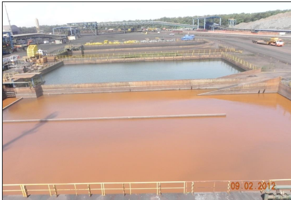
Figura 39: Tanques de decantação de minério de ferro (à frente) e de carvão mineral (ao fundo). (Fonte: Projeto Resíduos Portuários, 2012)
