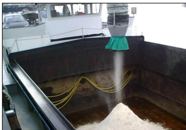
Figura 9: Equipamento telescoping chute em operação (Fonte: Telestack. 2012)
