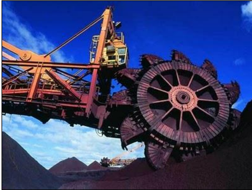
Figura 6: Recuperadora em operação (Fonte: 3In Tecnologia, 2012)
