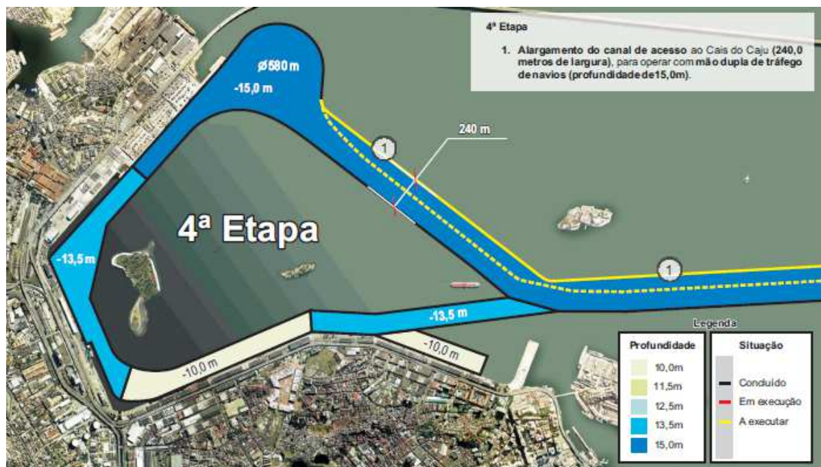
Figura 13 – Canal de Acesso após a última etapa de dragagem
