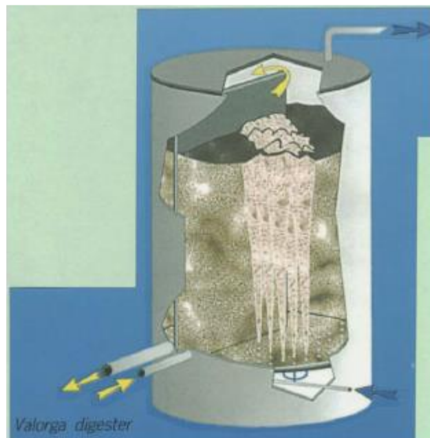
Figura 4 - Digestor de Estágio Único e Digestão Seca VALORGA
