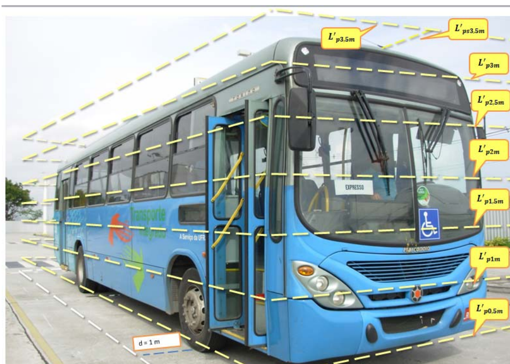
Figura 23 - Medição 6: Superfície de medição com as alturas das varreduras e distância de medição
