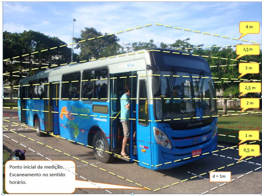
Figura 21 - Medição 4: Superfície de medição com as alturas das varreduras, distância de medição e sentido percorrido
